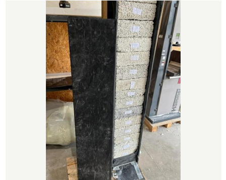
Ansicht der Dämmschicht im Versuchsaufbau.
