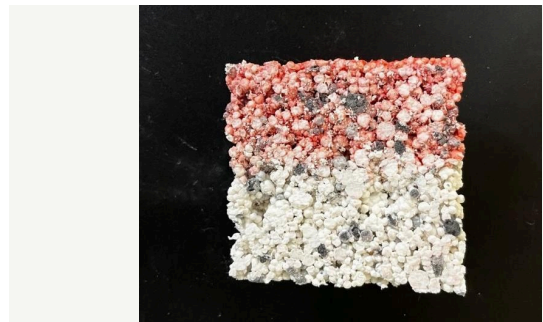
Anschnitt der Materialprobe mit sichtbarer Färbung.
