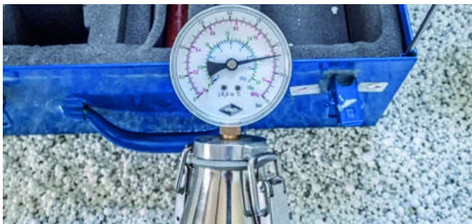
Restfeuchtigkeit und Ebenheit prüfen.
